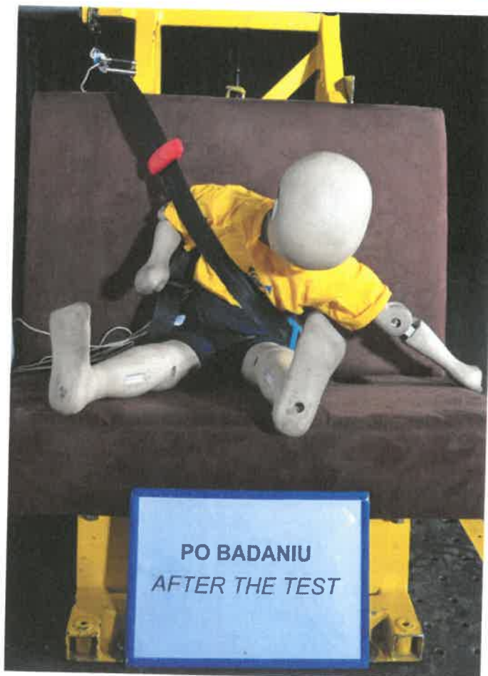
Fot. 4. Dziecięce urządzenie przytrzymujące po teście dynamicznym z manekinem o masie 15 kg Pic 4. Child restraint system after dynamic test using 15 kg dummy
