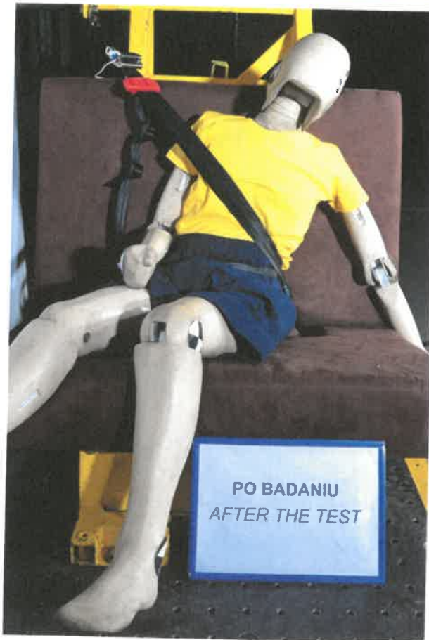
Fot. 5. Dziecięce urządzenie przytrzymujące po teście dynamicznym z manekinem o masie 32 kg Pic 5. Child restraint system after dynamic test using 32 kg dummy
