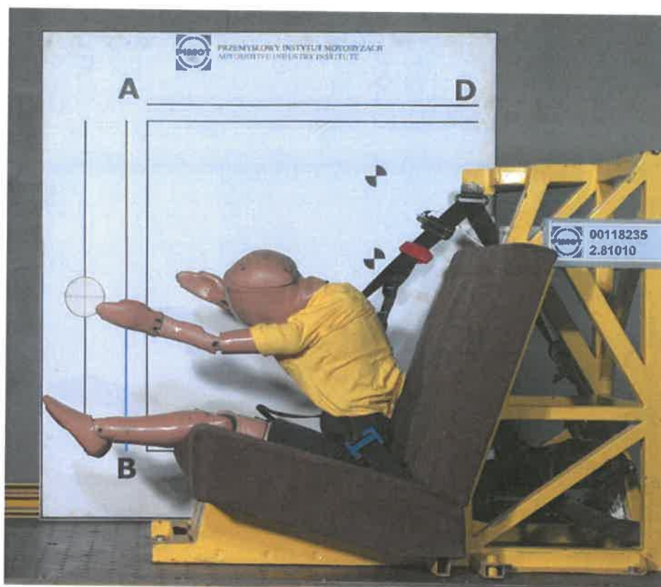
Fot. 2. Maksymalne przemieszczenie głowy manekina 22 kg podczas testu dynamicznego Pic. 2. Maximum displacement of the head 22 kg dummy during dynamic test
