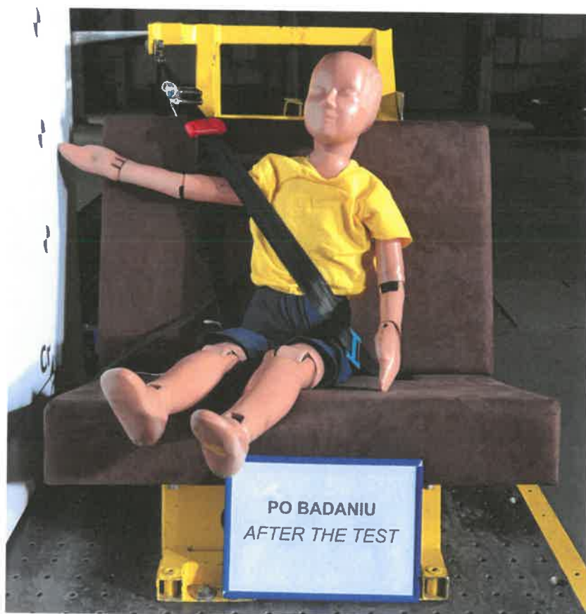
Fot. 4. Dziecięce urządzenie przytrzymujące po teście dynamicznym z manekinem o masie 22 kg Pic 4. Child restraint system after dynamic test using 22 kg dummy
