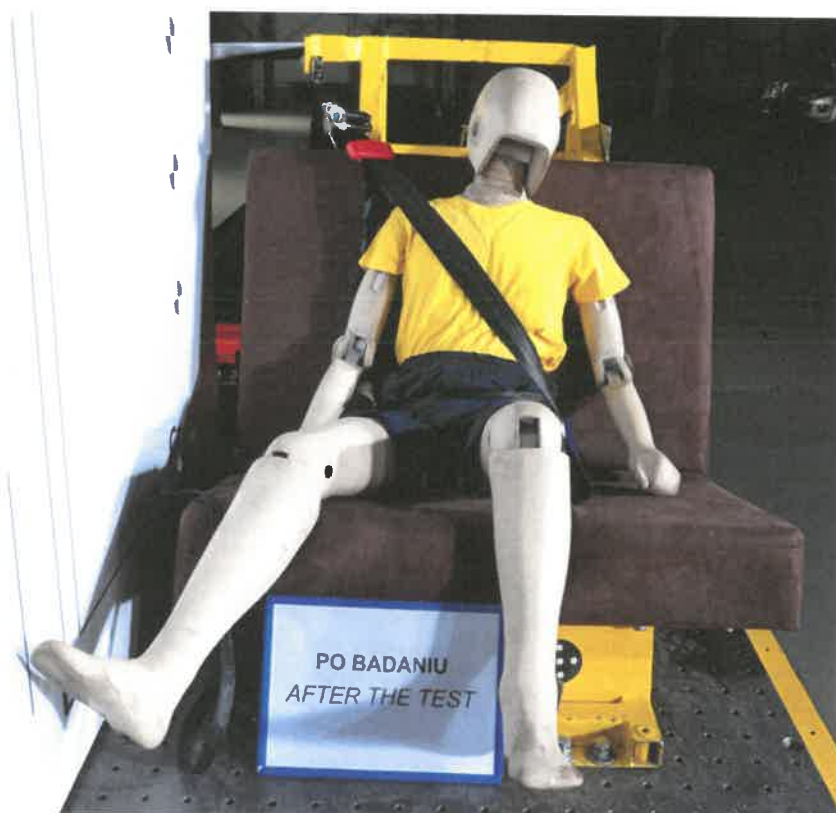
Fot. 5. Dziecięce urządzenie przytrzymujące po teście dynamicznym z manekinem o masie 32 kg Pic 5. Child restraint system after dynamic test using 32 kg dummy
