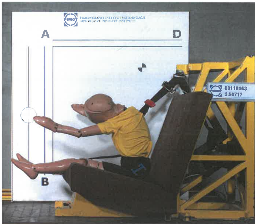
Fot. 2. Maksymalne przemieszczenie głowy manekina 22 kg podczas testu dynamicznego Pic. 2. Maximum displacement of the head 22 kg dummy during dynamic test
