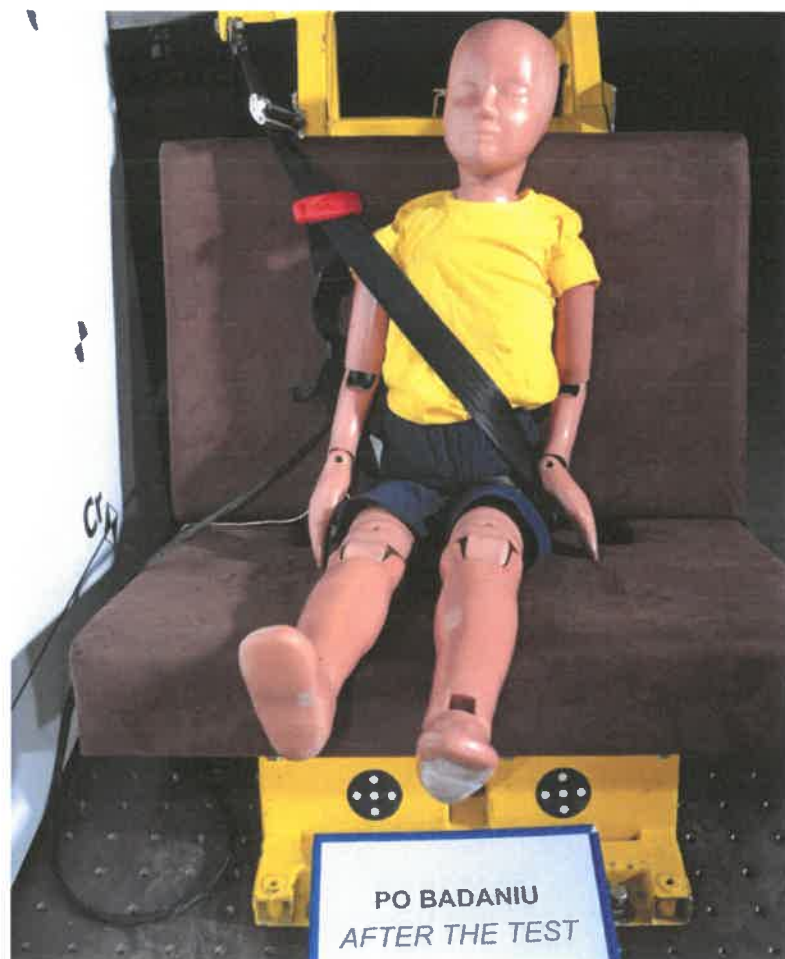
Fot. 4. Dziecięce urządzenie przytrzymujące po teście dynamicznym z manekinem o masie 22 kg Pic 4. Child restraint system after dynamic test using 22 kg dummy
