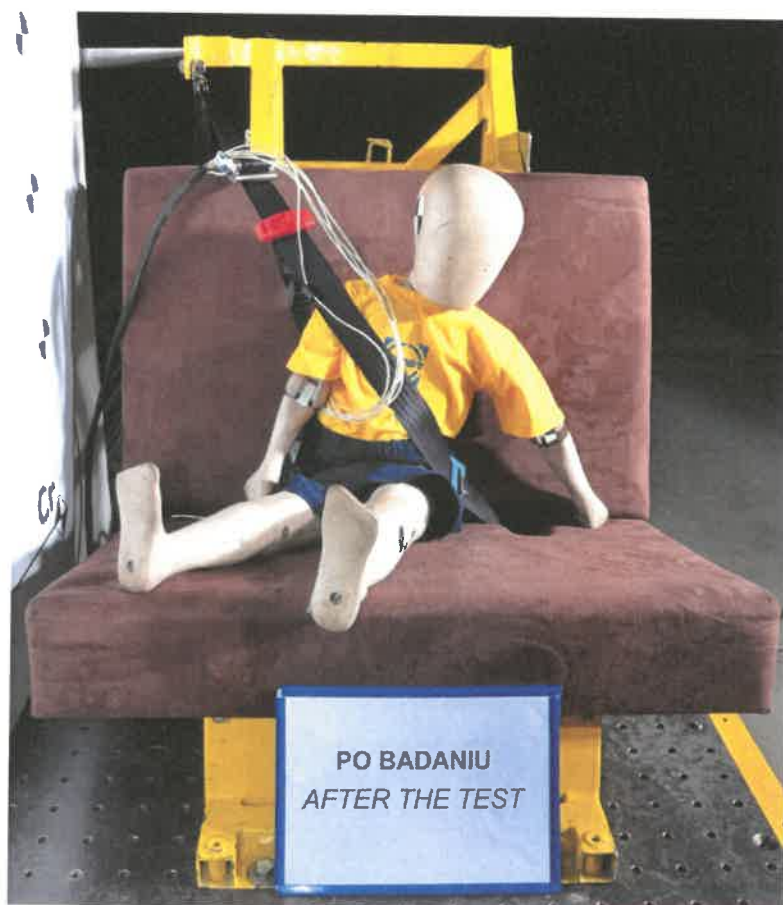
Fot. 4. Dziecięce urządzenie przytrzymujące po teście dynamicznym z manekinem o masie 15 kg Pic 4. Child restraint system after dynamic test using 15 kg dummy
