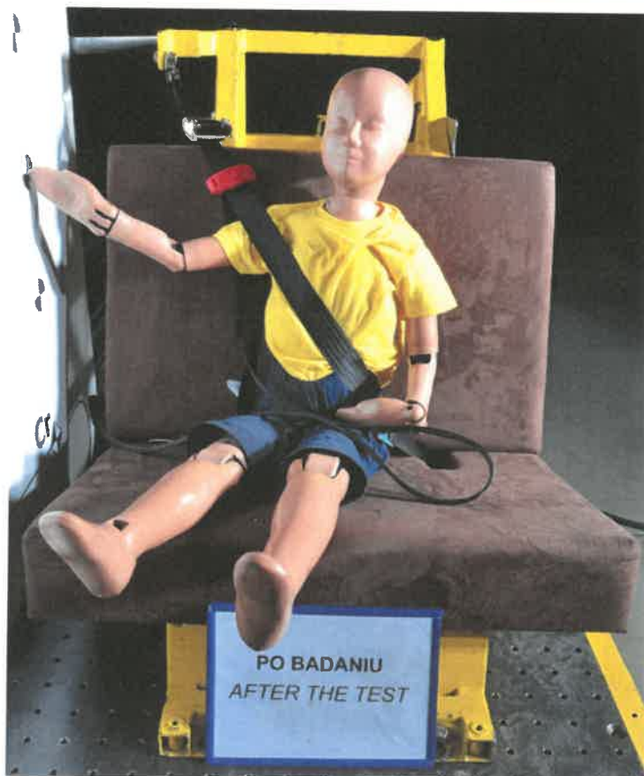
Fot. 5. Dziecięce urządzenie przytrzymujące po teście dynamicznym z manekinem o masie 22 kg Pic 5. Child restraint system after dynamic test using 22 kg dummy
