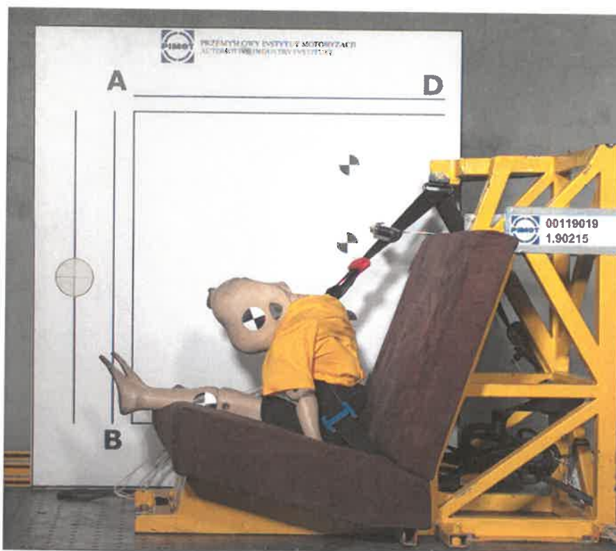
Fot. 2. Maksymalne przemieszczenie głowy manekina 15 kg podczas testu dynamicznego Pic. 2. Maximum displacement of the head 15 kg dummy during dynamic test
