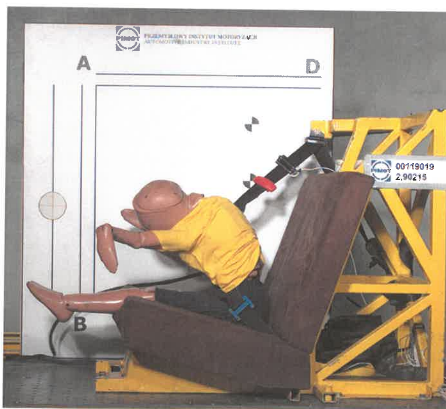
Fot. 3. Maksymalne przemieszczenie głowy manekina 22 kg podczas testu dynamicznego Pic. 3. Maximum displacement of the head 22 kg dummy during dynamic test
